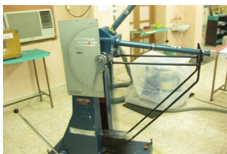
[Table/Fig-4]: Impact Testing Machine (Enkay Pr 09/E1/16)
